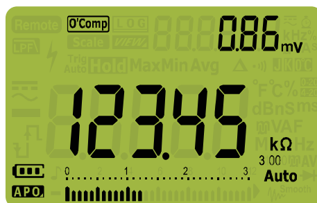
図 2-16 スマートΩ (バイアス電圧) 表示
