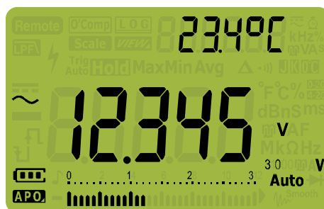
図 2-1 AC 電圧表示
