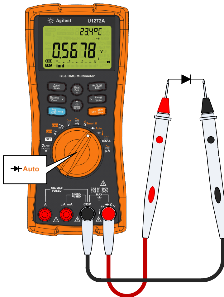
図 2-20 正バイアス・ダイオードのテスト
