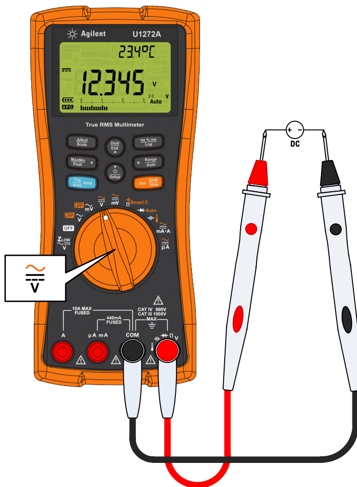
図 2-6 DC 電圧の測定
