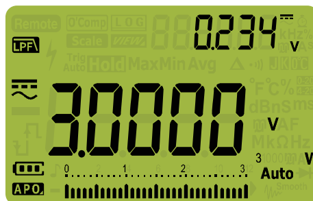
図 2-4 DC 結合の AC + DC 電圧測定
