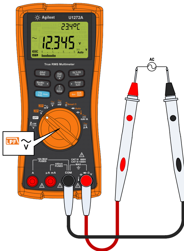
図 2-2 AC 電圧の測定
